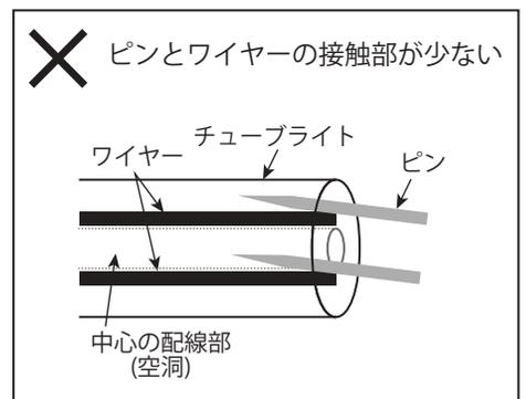
※中心の配線部(空洞)や他のワイヤー部分にピンが突き抜けないう、充分にお気を付けてください。
